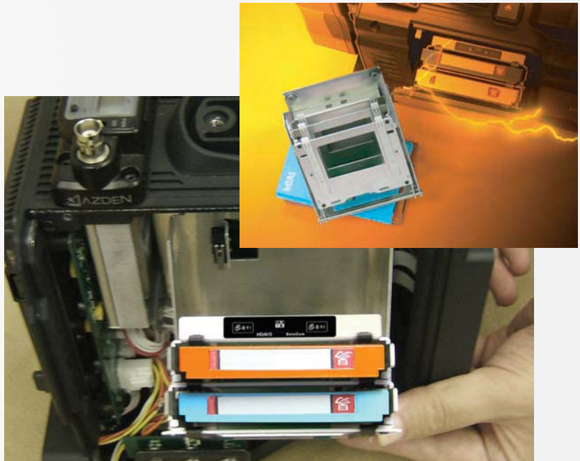
耐冲击震动的双盘卡机构设计
