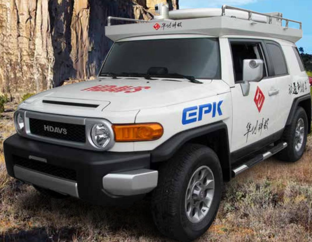
“EPK 动通制播车”集“静动通”、SNG、节目制播、国际海事卫星 BGAN 为一体；整合 3G/LTE/WiFi/OFDM 于统一平台；提供并发的 DVB-S/S2、TCP/IP、UDP/IP 卫星直播和节目素材的传输；实现移动静止中音视频高效及时的拍摄采集、编辑录制、播出存储、内容交互的创新理念。
